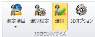
「3D カウント/サイズ」グループの「測定項目」をクリックすると、立体計測用の各種測定項目を選択できます。「3D カウント/サイズ」の測定は、「カウント」ボタン (5ページ) や「ガイド式対象抽出」 (7ページ) を使用して、立体像に等値面体 (14ページ) を作成することで行ないます。
